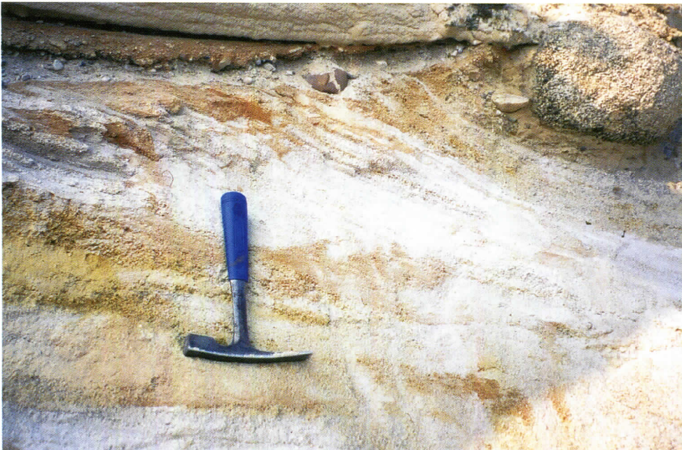
Bild 20 Nordische Geschiebe an der Quartärbasis über dem oberen Kiessandhorizont der Rauno-Formation (Nordböschung des Tagebaus Klettwitz)
