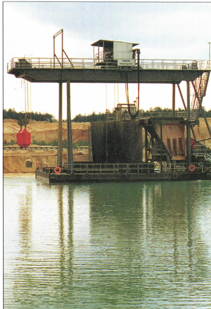
oben: Der meiste Kies wird in diesem Abbau mit einem modernen Schwimmbagger gefördert.
