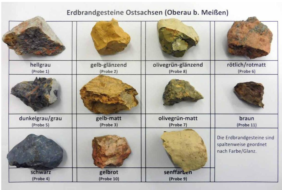
Abb. 5 | Farbe und Glanz der untersuchten Erdbrandgesteine.
