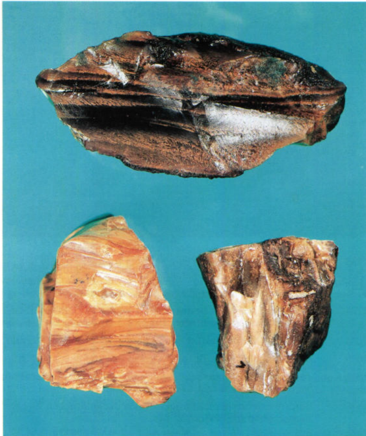
Abb. 2: Gessit-Varietäten aus untermiozänen Sedimenten des Baunkohletagebaues Lohsa/OL: oben: schwarzbraune Varietät; unten links: gebändert orange-gelbe Varietät; unten rechts: hellbraune Varietät. Größen: 7,5 – 10 cm. Coll. W. Sauer.
